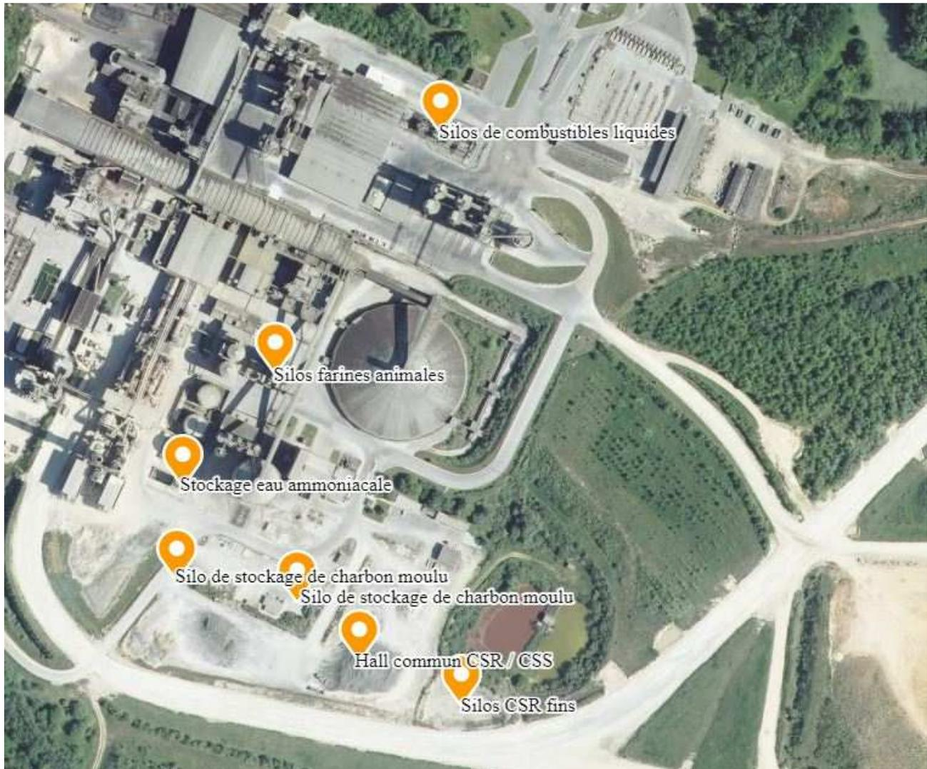
**Figure 1 : Plan de localisation des stockages de combustibles et de l'eau ammoniacale (Sources : CEMENTS CALCIA)**
